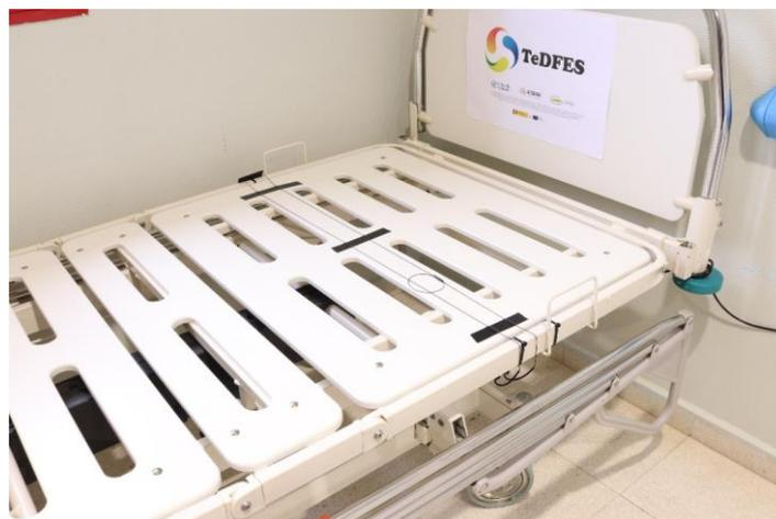
**Ilustración de la situación del transductor del sensor de fibra óptica sobre el somier de la cama y bajo el colchón en el servicio de Cardiología del HUMV.**
