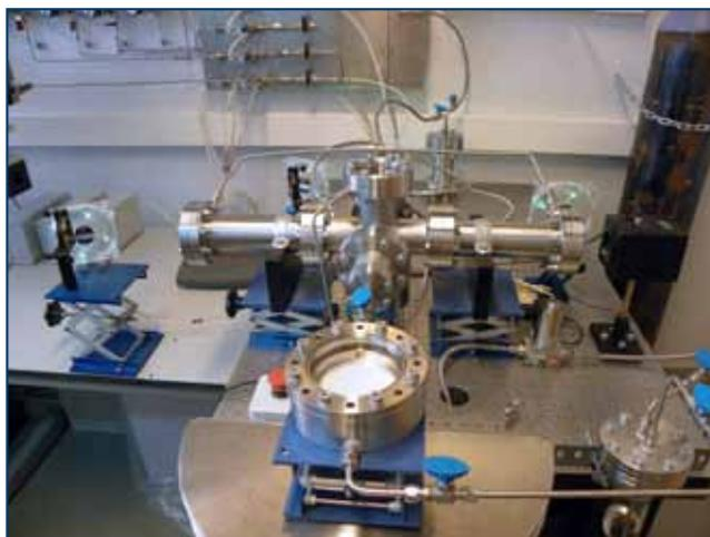
*Reactor de pirólisis inducida por láser para síntesis controlada de nanopartículas a partir de precursores en fase vapor, aerosoles y mezclas vaporizadas de gases y líquidos.*
